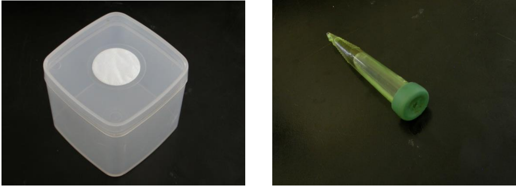
Figure 4.3 Boîte « life guard » et contenant fournissant l'eau nécessaire aux tiges végétales.
